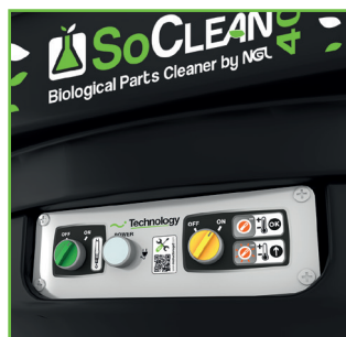
Boîtier électromécanique démontable sans outils
