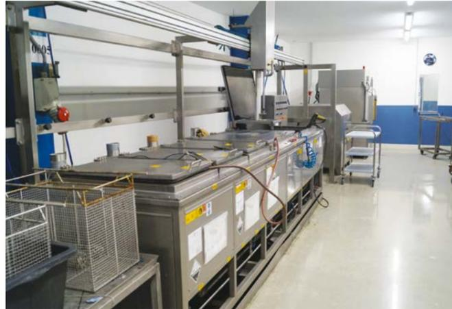
NGL développe et propose des solutions ainsi que des services de décapage pour les petits forêts, mais aussi pour les grosses pièces tels que les moules, d'un diamètre jusqu'à 1,5 m et d'un poids jusqu'à 5 tonnes.
